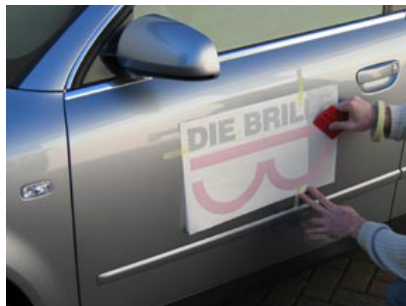
5. Übertragungsfolie m. d. Schriftzug auf den Untergrund auflegen und mit der Raker fest andrücken. Anstelle der Raker kann auch ein Tuch, oder eine Walze verwendet werden.
