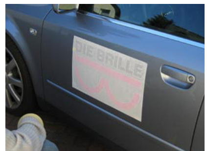
9. Die komplett aufgeklebte Folie noch einmal fest andrücken.
