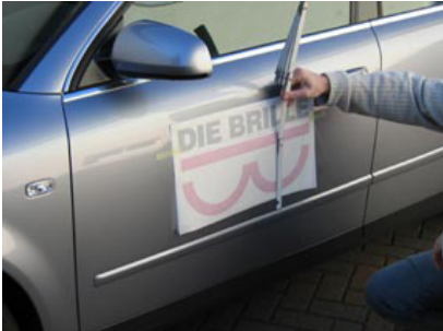
1. Untergrund mit Spiritus fettfrei reinigen. Schriftzug bzw. Logo einmessen.
